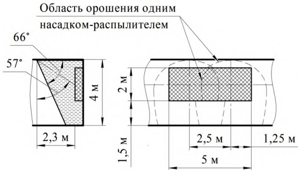
Рисунок 10. Противопожарная защита навесного шкафа 2-мя насадками-распылителями
