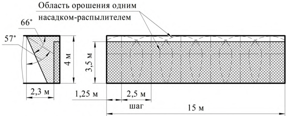
Рисунок 9. Противопожарная защита стеллажа 6-ю насадками-распылителями
